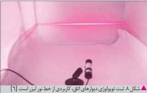
▲ شکل ۸. ثبت توپولوژی دیوارهای اتاق، کاربردی از خط نور لیزر است. [۶]
